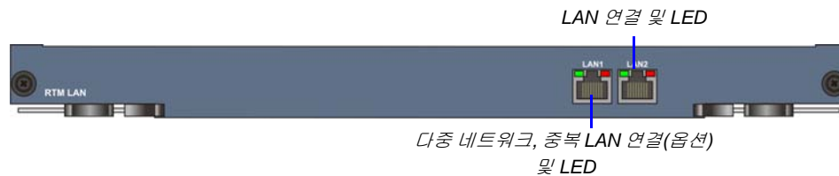
그림 1-13 RMX 4000 RTM LAN 뒷면 패널 레이아웃
